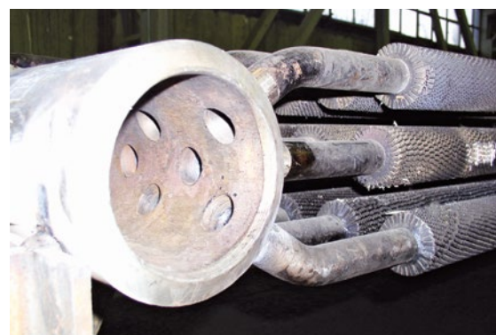
مونتاژ هارپ های نیروگاه های سیکل ترکیبی
