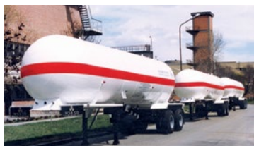
LPG Two & Three AXLE Semitrailers, Cap.: 9800 Gal. مخزن حمل گاز مایع با ظرفیت ۹۸۰۰ گالن دو و سه محوره
