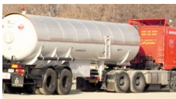
Propane Semitrailers Cap.: 9800 Gal. مخزن حمل پروپان با ظرفیت ۹۸۰۰ گالن
