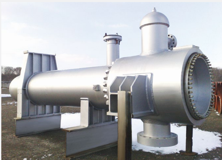
مبدل حرارتی Breech-Lock واحد ایزوماکس پالایشگاه امام خمینی سازند Imam Khomeini refining isomax unit Breech-lock heat exchanger
