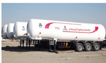
Ammonia Semitrailers Swan Shape Cap.:11700 Gal. مخزن حمل آمونیاک با ظرفیت ۱۷۰۰ گالن قوی شکل
