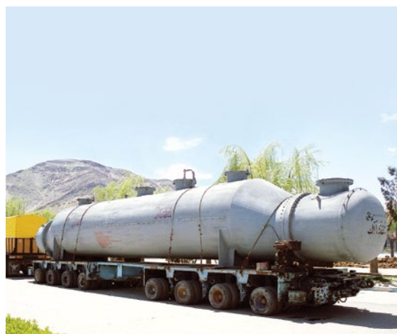
مبدل حرارتی متانل به وزن ۸۰ تن Methanol heat exchanger, weight: 80 tons
