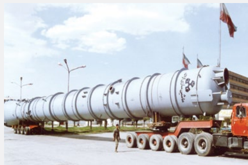
برج پتروشیمی بوعلی (آروماتیک) Buali petrochemical aromatic distillation tower
